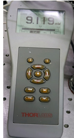
Şekil 20. 25^{\circ}\text{C} 'de, Atmosfer basıncında, eşik akımında lazer ışık gücü
