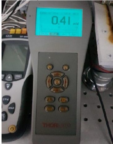
Şekil 21. 25^{\circ}\text{C} 'de, Atmosfer basıncında, eşik akımında, harici geri beslemeli lazer ışık gücü
