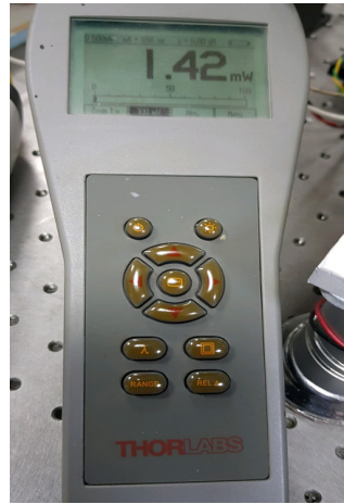
Şekil 22. -50.03^{\circ}\text{C} ~1 mbar basınç değerinde eşik akımında lazer ışık gücü
