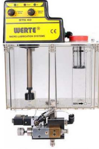
Şekil 1. Werte marka MQL cihazı.
