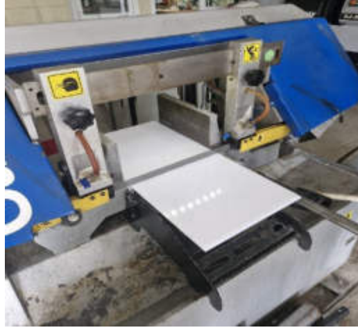
Şekil 2. Kaynak numunelerinin testere tezgahında kesilerek hazırlanması
