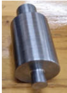
Şekil 4. Deneysel çalışmada kullanılan uç kısmı dışa doğru konik sürtünme karıştırma nokta kaynak takımı
