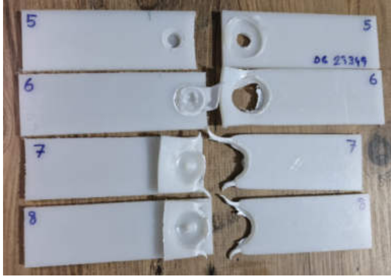
Şekil 7. Çekme deneyi uygulanmış PE SKNK numunelerinin, çekme deneyi sonrası fotoğrafları
