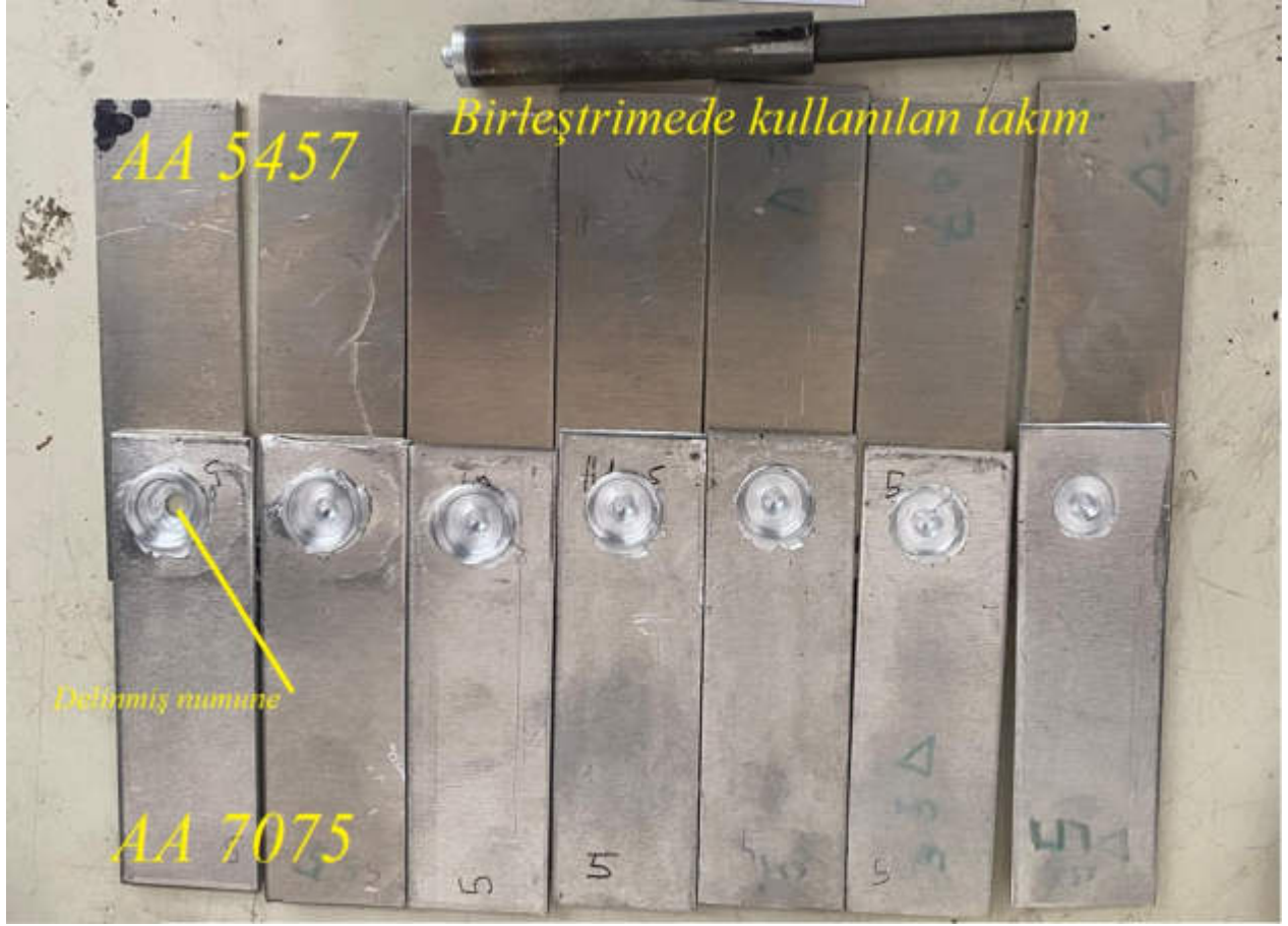
Şekil 2. Sürtünme karıştırma nokta kaynaklarını üstten çekilmiş resimleri
