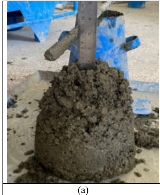
Şekil 3. C40 betonuna slump deneyi (a) çökme değeri
