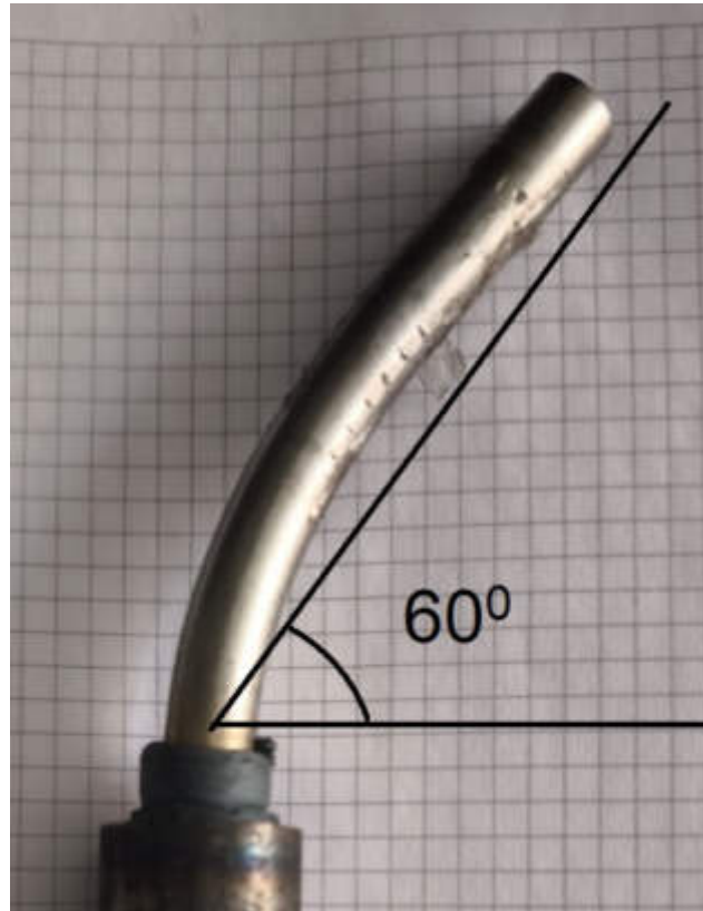
Şekil 8. Birleştirilen numunelerin eğme testi sonrası görüntüsü
