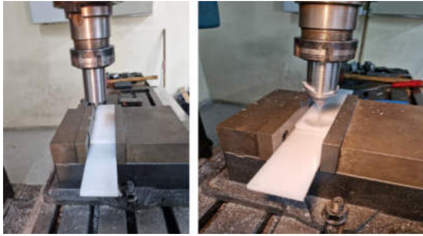
Şekil 5. Deneysel çalışmada SKNK numunelerin mengene ile tezgah tablasına bağlanması ve yöntem uygulanırken çekilen fotoğrafları
