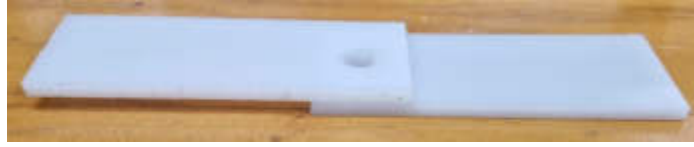
Şekil 3. Sürtünme karıştırma nokta kaynağı için Polietilen numunelerin bindirme şekli
