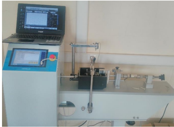
Şekil 2. Deneylerde kullanılan kesme kutusu cihazı
